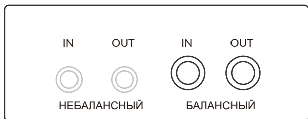
4.4мм балансный IN/OUT
