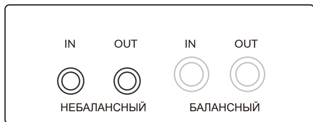
3.5мм небалансный IN/OUT
